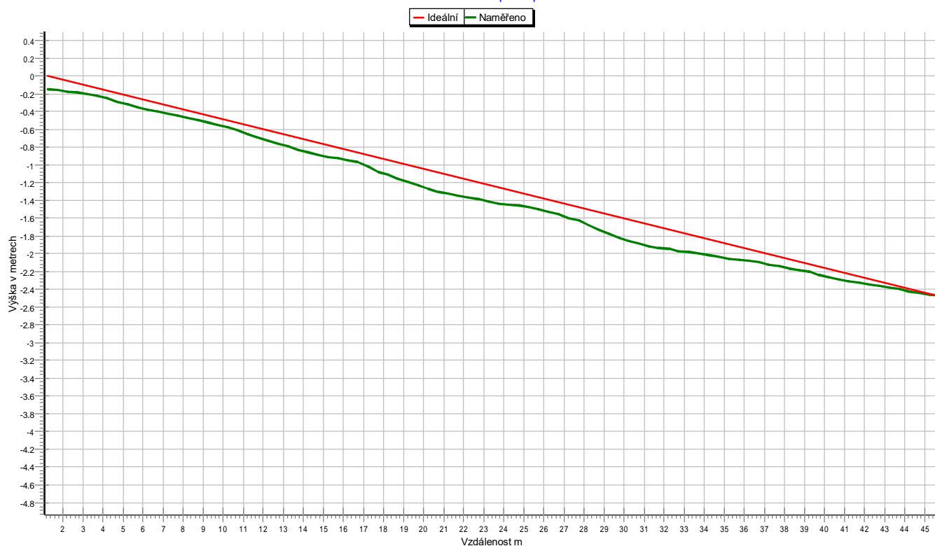
Grafické znázornění spádu potrubí
