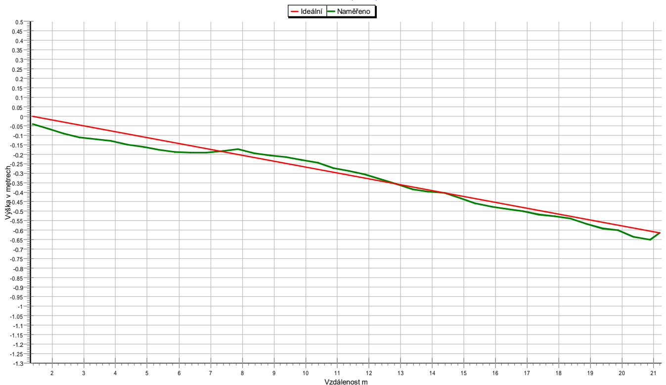
Grafické znázornění spádu potrubí
