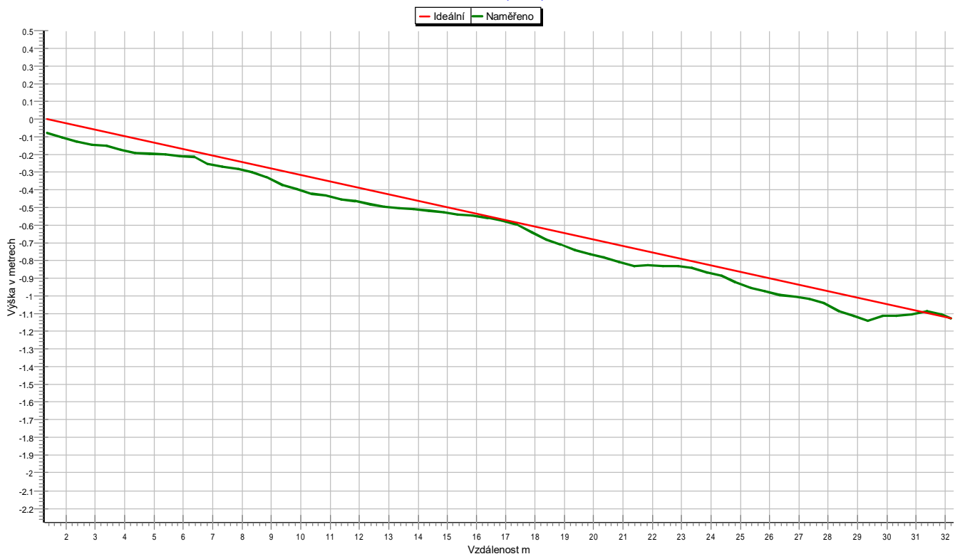
Grafické znázornění spádu potrubí
