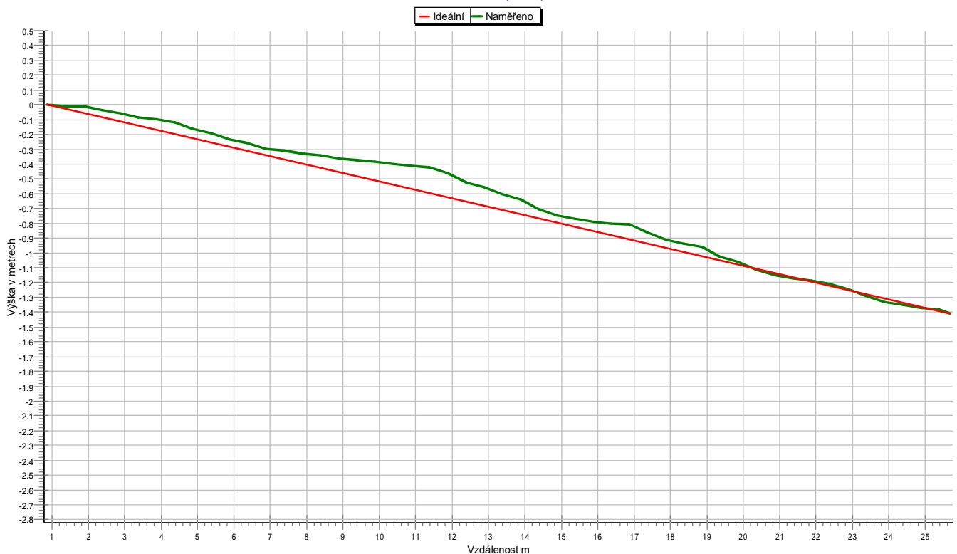
Grafické znázornění spádu potrubí
