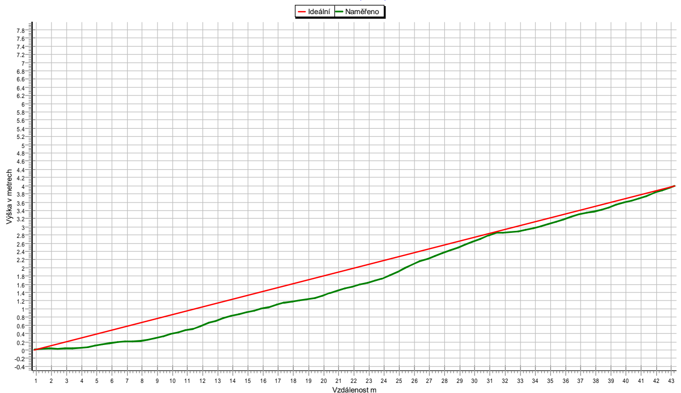
Grafické znázornění spádu potrubí
