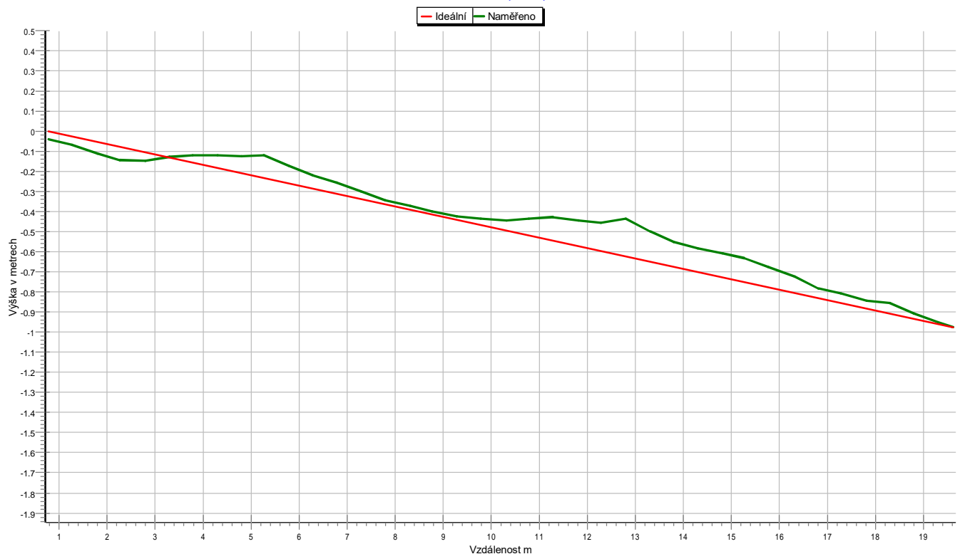
Grafické znázornění spádu potrubí
